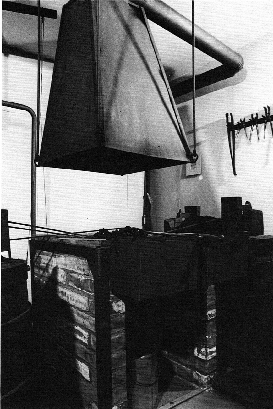
Die Esse mit Hurd, Kohle- und Wasserbehälter und Kohleschäufelchen
