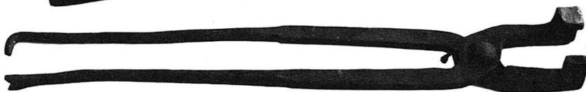
Zange zum Halten der Nageleisen und leichter Ambosse. Länge: 64 cm
