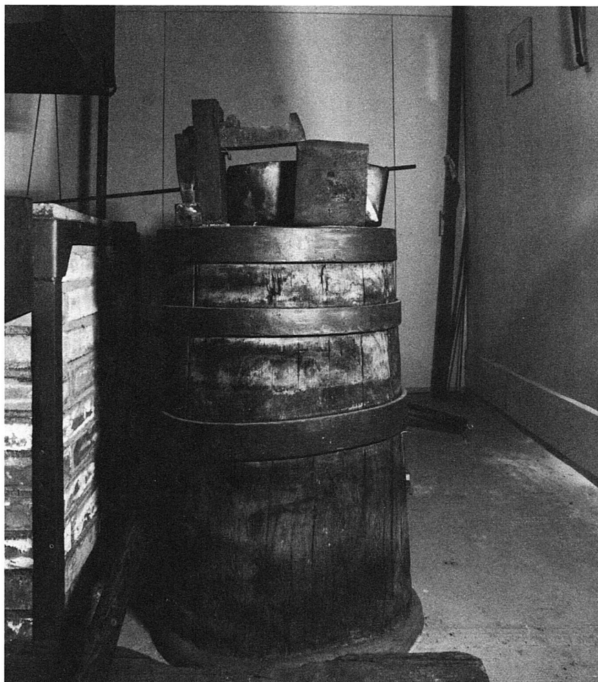
Nagelstock. Unterhalb des untersten Reifs Löcher für den Austritt des Hammer-schlages. In der Ecke Eisenstäbe, aus denen die Nägel geschmiedet werden
