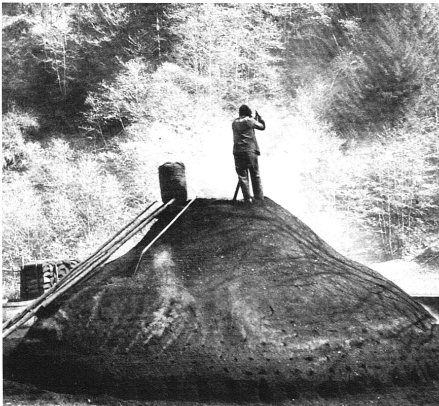
Der Köhler reguliert die von oben nach unten fortschreitende Verkohlung mit Luftlöchern, die er mit einem Stecken in den Mantel sticht.
