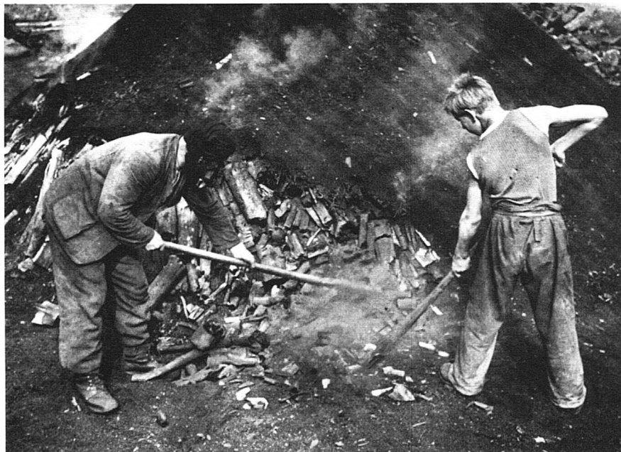
Vorsichtig bricht der Köhler den Mantel auf und zieht die darunterliegende Holzkohle heraus.
