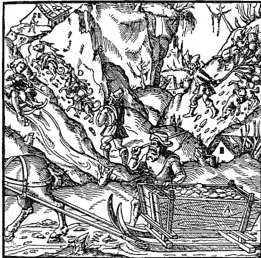
Ein Schlitten A. Eine Schleife mit Säcken B. Der Stab C. Die Hunde mit Saumfitteln D. Die an einem Strick befestigten schweinsledernen Säcke E.
