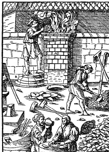
Der Ofen A. Die Stufen B. Erz C. Kohlen D.
