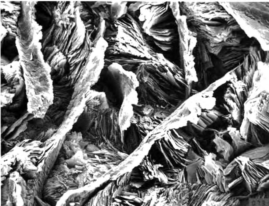
Raster-Elektronenmikroskop-Aufnahme von Gusseisen mit Lamellengraphit
