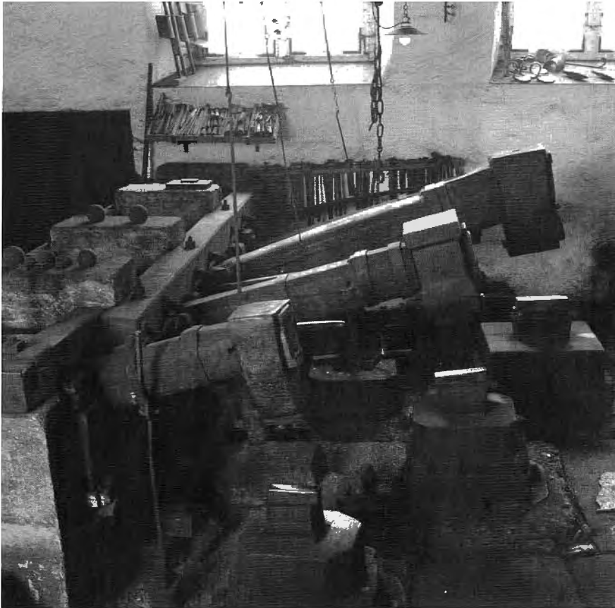
Die Antriebswelle aus Eichenholz ist auf Stein gelagert.
